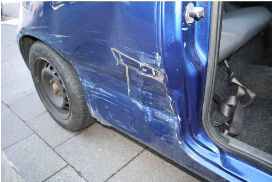
Bild 12: Die B-Säule wurde stark verformt und beschädigt.
