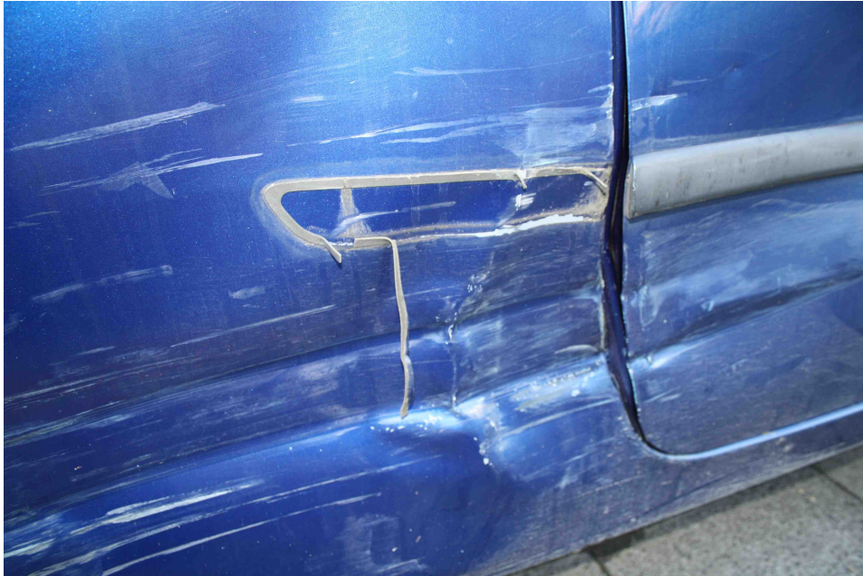
Bild 7: Die rechten Stoßleisten wurden beschädigt.
