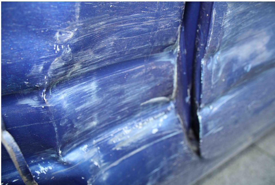
Bild 9: Die rechte Tür wurde stark ins Fahrzeuginnere eingedrückt und beschädigt.
