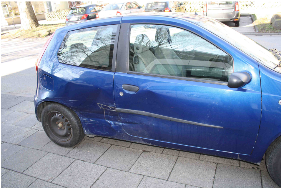
Bild 3: Das Fahrzeug wurde von der rechten Seite pressend und streifend breitflächig ins Fahrzeuginnere eingedrückt.
