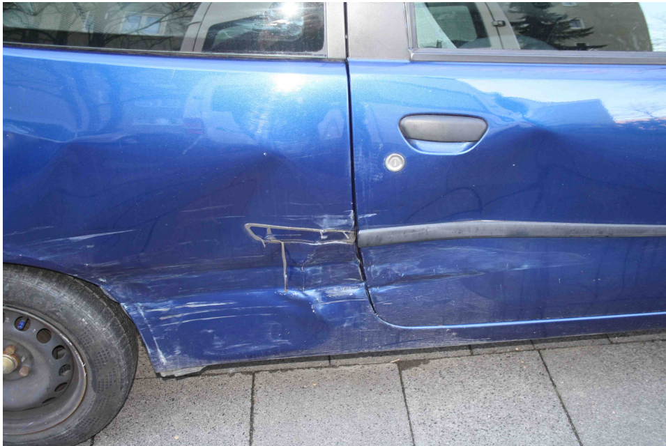
Bild 5: Die hintere rechte Seitenwand wurde stark beschädigt.
